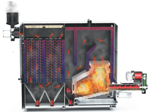
Moderni kotao na biomasu s pomičnom rešetkom i automatiziranim mehaničkim čišćenjem izmjenjivača topline
